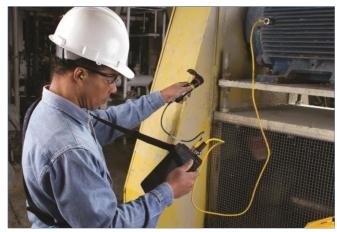
El sensor de velocidad 430 láser AMS determina la velocidad del eje sin necesidad de apagar la máquina - incluso en lugares muy estrechos.
