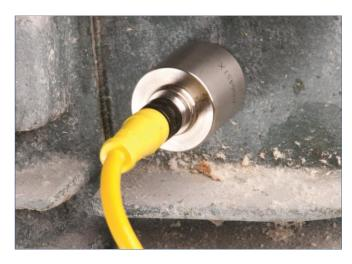
El acelerómetro triaxial recoge datos en el lugar de medición de una dirección vertical, horizontal, y axiales simultáneamente.
